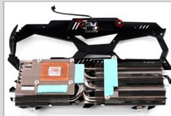
4. 拆除图中标红位置螺丝
