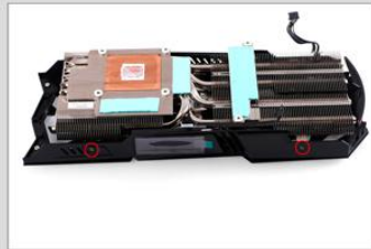
3. 拆除图中标红位置及对面4颗螺丝， 取下风扇，放好两颗螺丝备用
