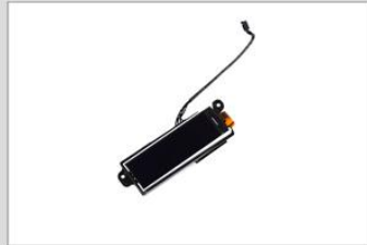
5. 小心取下原装显示屏，撕掉保护膜
